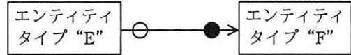
図2 対応関係にゼロを含むか否かを区別して表現する場合の表記ルール
